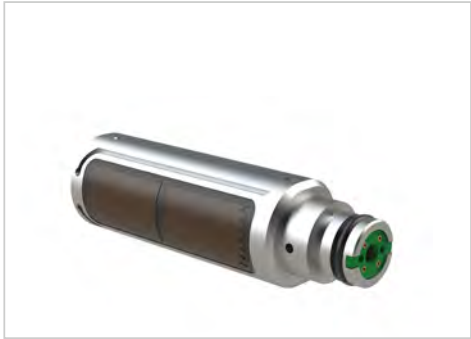
空心螺栓检测
