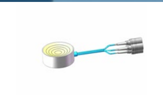
多环形自聚焦探头,多环阵晶片构象,可实现深度方向焦距可调。
